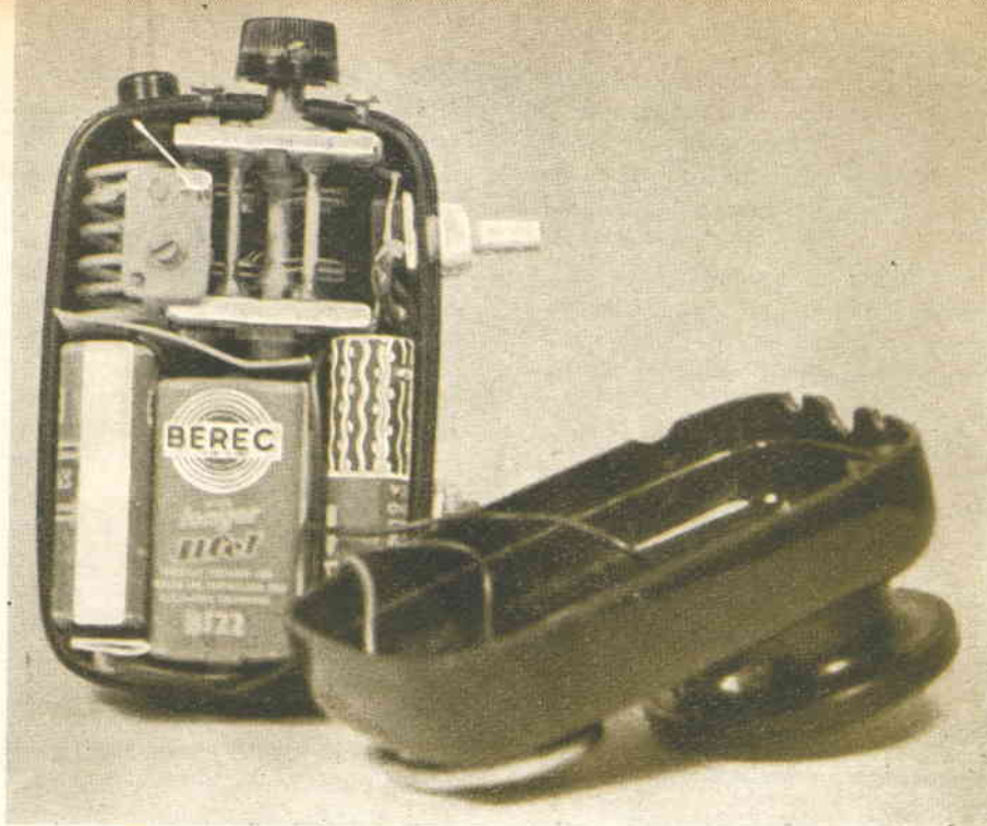
Radiotelefono con le pile inserite al proprio posto.
